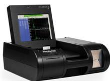
O Itemiser® 5X é uma versão avançada do Itemiser® 4DX, oferecendo melhorias em detecção de vestígios de explosivos e narcóticos. Utiliza uma fonte de ionização não radioativa, eliminando a necessidade de testes anuais e licenciamento. A detecção simultânea em aproximadamente 8 segundos melhora a precisão e eficiência operacional.
