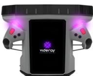
Dispositivo portátil de raio-x com tecnologia de retro espalhamento, projetado para inspeção rápida de superfícies e identificação de objetos ocultos. Leve e ergonômico, pesa 4,3 kg, ideal para uso prático. Com uma fonte de 140 keV. Inclui conectividade Wi-Fi, Bluetooth, GPS e USB, com bateria recarregável que proporciona até 6 horas de operação.
